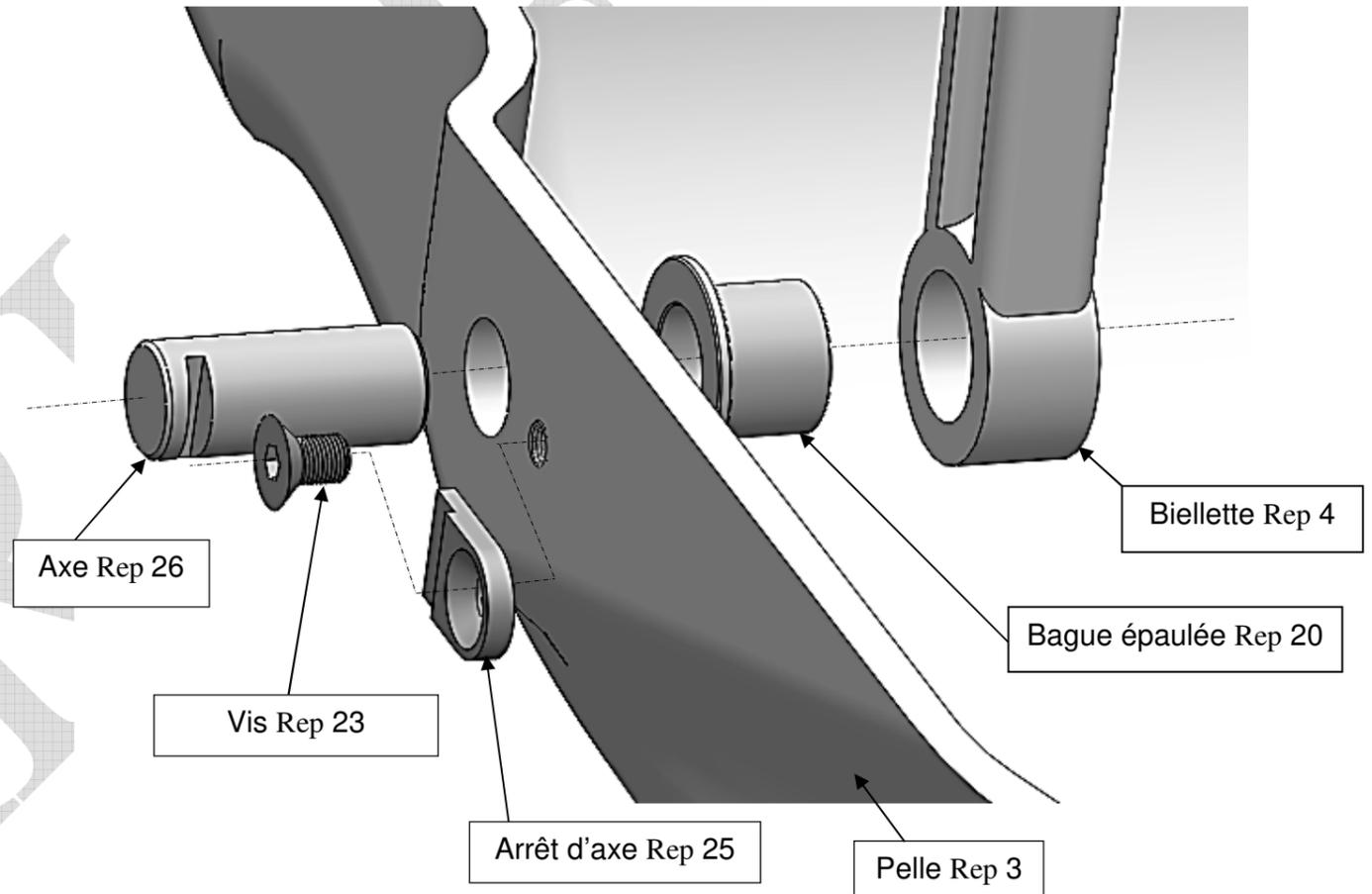
Ce principe d'assemblage est utilisé 12 fois sur le système, dont 4 fois pour les pivots des deux biellettes.
