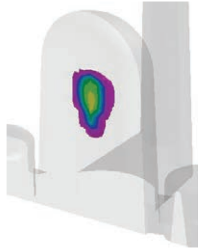
Figure 3. Shrinkage and Misrun - tps=330s à gauche (critère d'arrêt atteint) Zoom et coupe au niveau de la masselotte à droite
