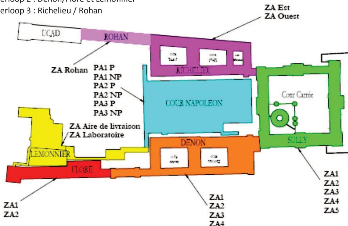
Le site est surveillé par 26 systèmes de détection incendie. Il est décomposé en 22 zones d'alarmes (ZA).
