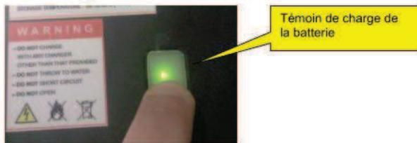
Avant d'installer une batterie sur le drone, le technicien doit vérifier son niveau de charge en pressant sur le bas de la membrane translucide présent sur le dessus de la batterie.
