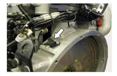
Le capteur incrémental de régime ou capteur de PMH est monté sur le carter de volant moteur.
