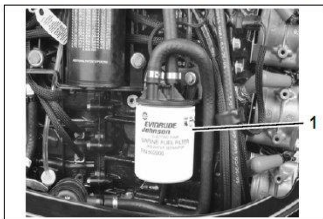
1. Filtre à carburant à séparateur d'eau
