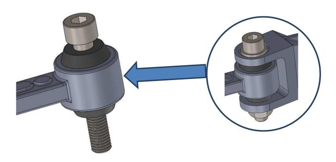
L'ajustement entre la vis et l'alésage de la biellette est :  $\emptyset$  8 H7 g6
