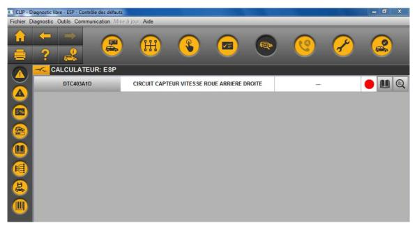
En contrôlant le capteur, vous constatez une rupture de son faisceau. Vous le réparez et décidez de contrôler votre réparation en vérifiant son signal.
