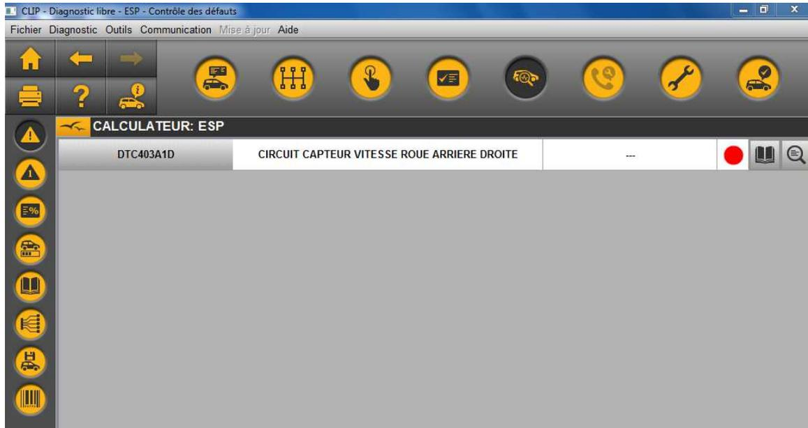
En contrôlant le capteur, vous constatez une rupture de son faisceau. Vous le réparez et décidez de contrôler votre réparation en vérifiant son signal.
