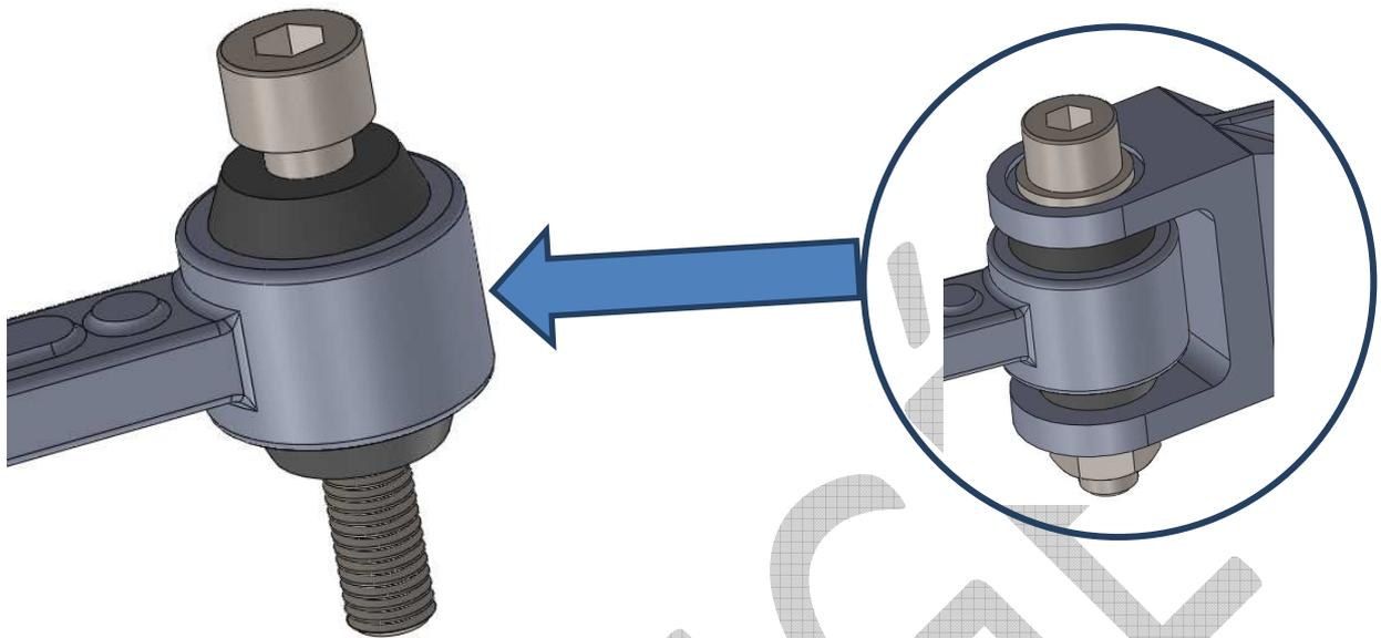
L'ajustement entre la vis et l'alésage de la biellette est :  $\varnothing 8 \text{ H7 g6}$
