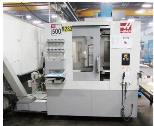
Vous allez réaliser la mise en œuvre de la fabrication de l'équerre de chape fixe pour la phase 20 sur un centre d'usinage horizontale 4 axes.
