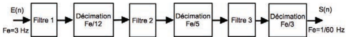
Figure 10 : filtrage et décimation des échantillons
