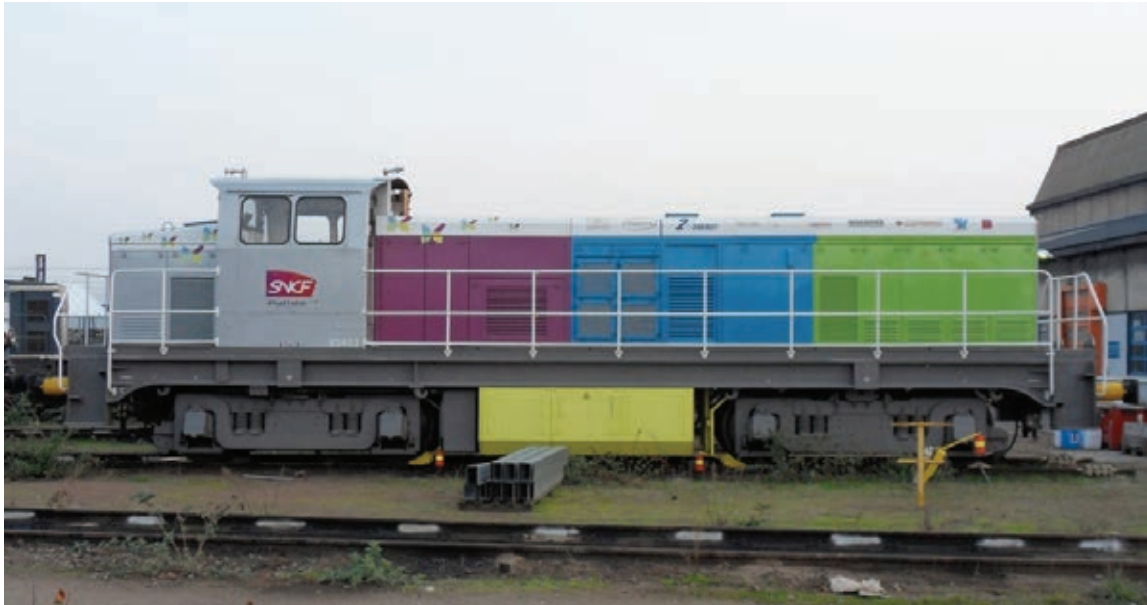
Figure 1 – Locomotive Plathée avec les différents secteurs (violet : groupe Diesel, bleu : pile à combustible, vert : supercondensateurs, jaune : batterie NiCd)
