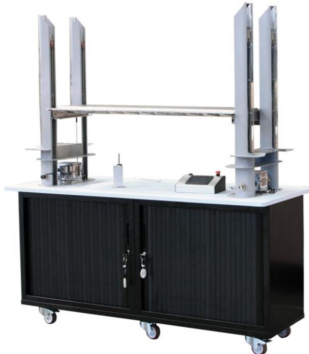
Figure 5 - Maquette du pont Chaban-Delmas
