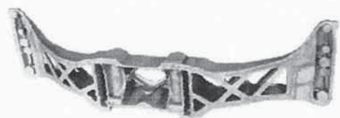
Solution DirectCast avec EOSINT S 750 : fabrication de traverse et usinage modèle support
