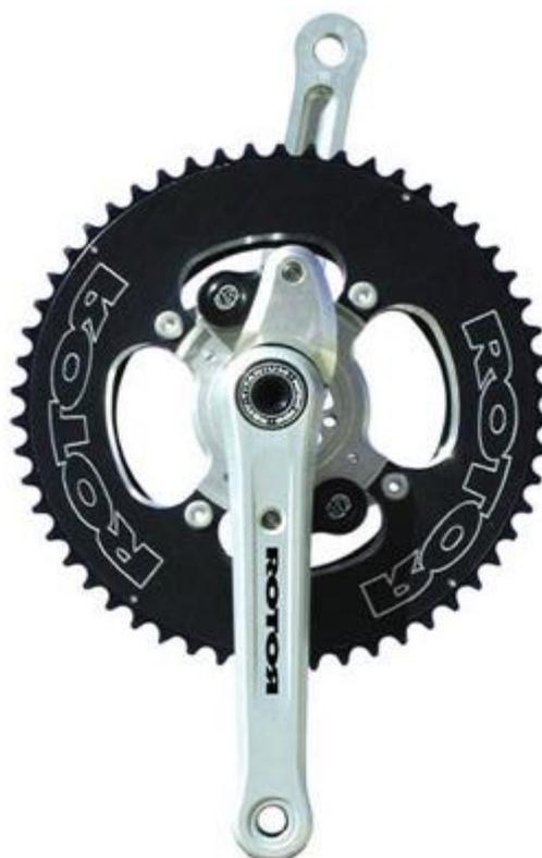
**RotorSystem** est un système de pédalage qui élimine les points morts. Contrairement à un pédalier classique où les manivelles sont à 180° l'une de l'autre, avec RotorSystem, elles font un angle variable de sorte que lorsqu'une pédale se trouve au point le plus bas, l'autre a déjà amorcé sa descente.
