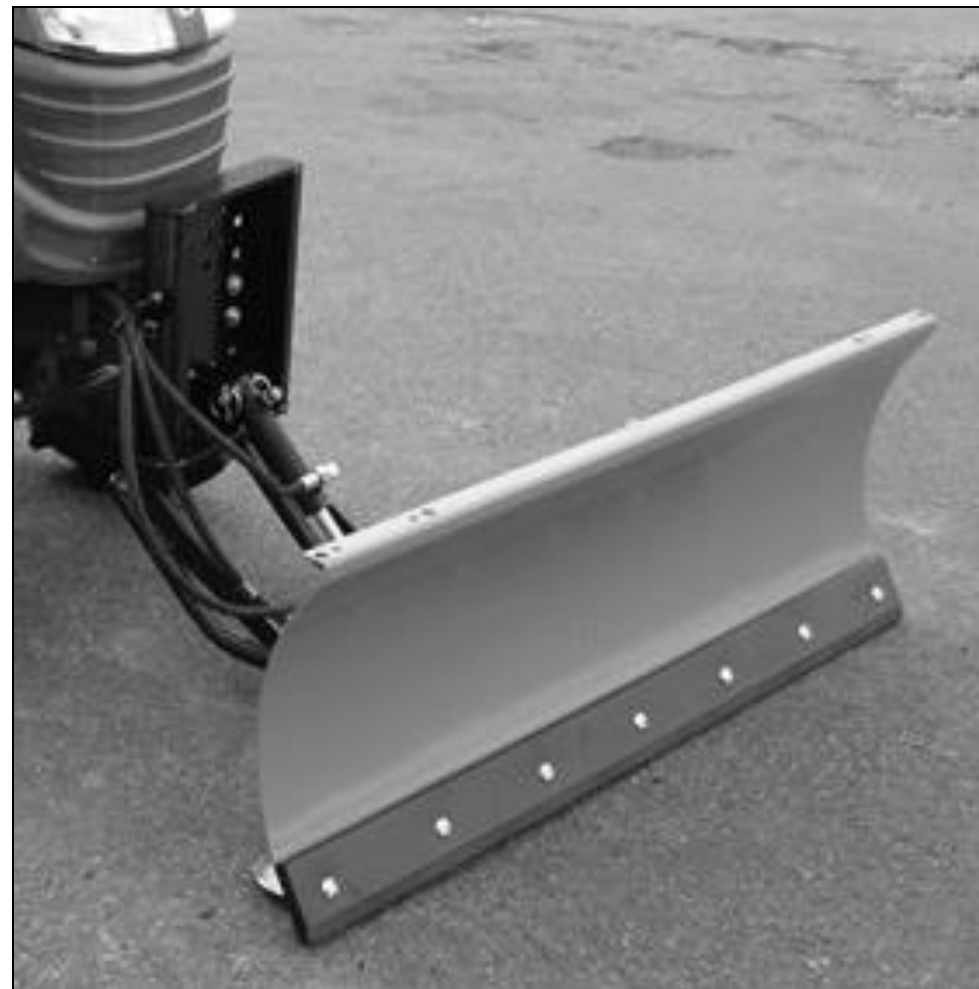
Exemple: montage universel d'une lame de 1300 mm
