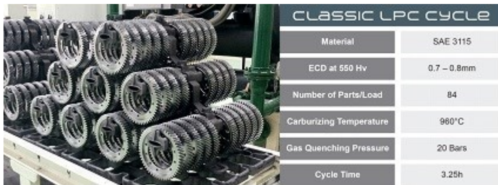
Fig. 3 : Charge de couronnes pour four de CBP
