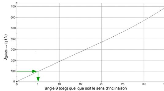
L'angle d'inclinaison maximal correspondant à un effort de 100 N est de  $5^\circ$ .
