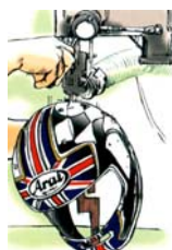
Perçage des trous de fixation de la visière N° 8
