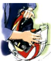
Assemblage des supports, de la visière, des aérations... N° 10
