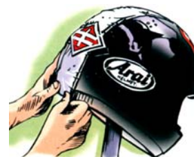
Pose des décalcomanies N° 7
