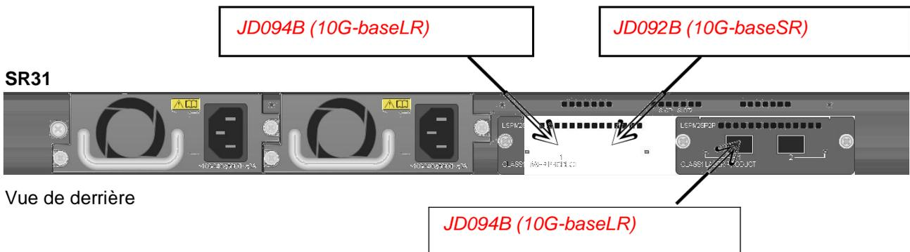
La liaison entre les commutateurs SR01 et SR31 est symbolisée ci-dessous. Les pigtaills sont lovés dans des tiroirs optiques de référence « GGM TIRRA12SC09 » au catalogue GIGAMEDIA. L'identification des types de connecteurs utilisés dans la liaison optique permettra de faire les choix de jarretière et de pigtail.
