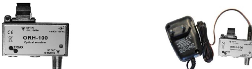
Ce récepteur est destiné à être installé chez l'abonné, il est intégré dans un boîtier robuste en fonte d'aluminium. Il est équipé d'un connecteur optique type SC/APC et d'une sortie des signaux 47 – 862 MHz sur un connecteur F femelle. Le niveau optique d'entrée peut être évalué à l'aide des indications fournies par la LED 3 couleurs.
