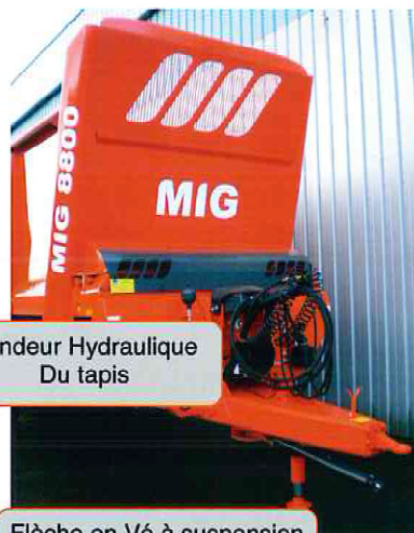
Flèche en V à suspension hydraulique semi-active
