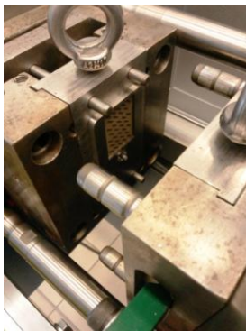
Injection de la râpe
