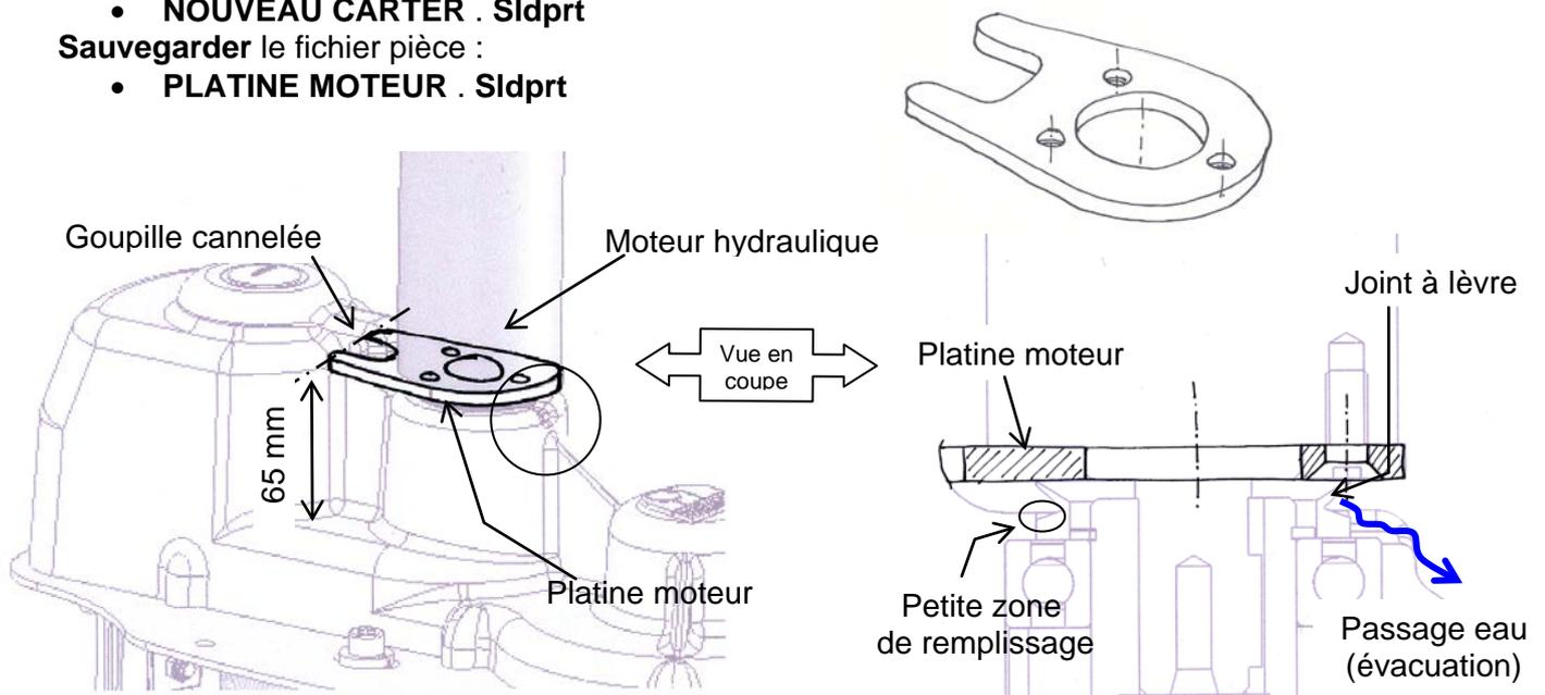
Un organe d'étanchéité doit être prévu (joint à lèvres) pour stopper les infiltrations d'eau entre la platine moteur et le carter.
