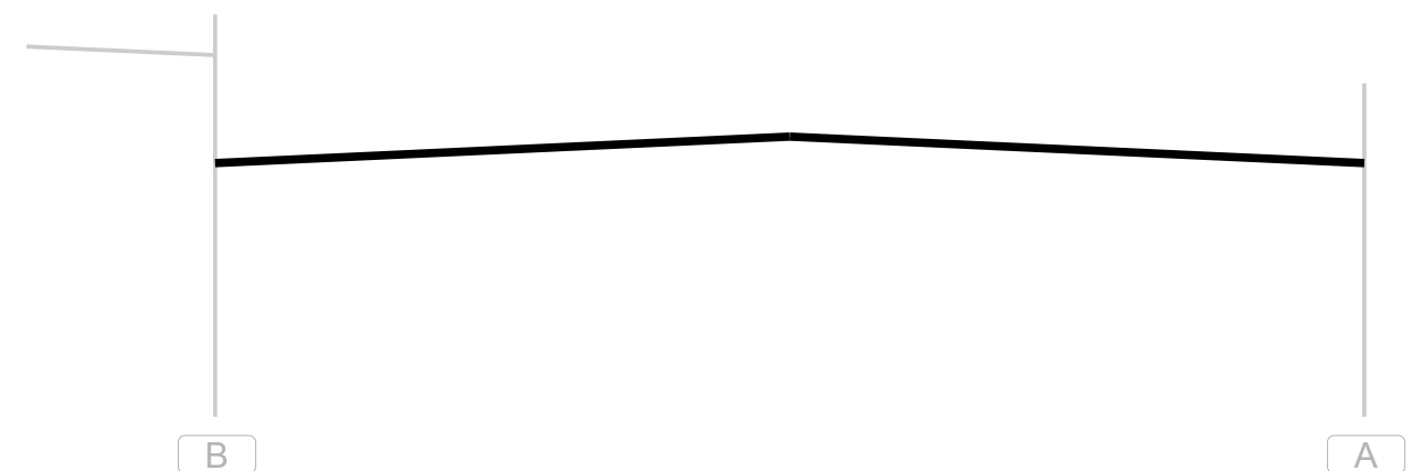
Schéma n° 5 – Diagramme de moment fléchissant M
