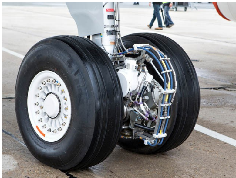
Prototype de l'EGTS monté sur un train d'atterrissage principal
