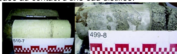
Figure 1 : Éprouvettes après essai de gonflement.
