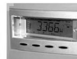
L'affichage sur l'onduleur permet de vérifier à tout moment la quantité d'électricité produite.
