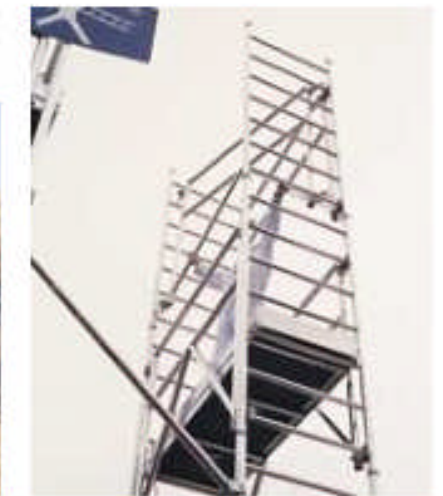
Figure 2. Échafaudage roulant en hauteur
