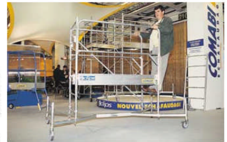
Échafaudage roulant de faible hauteur
