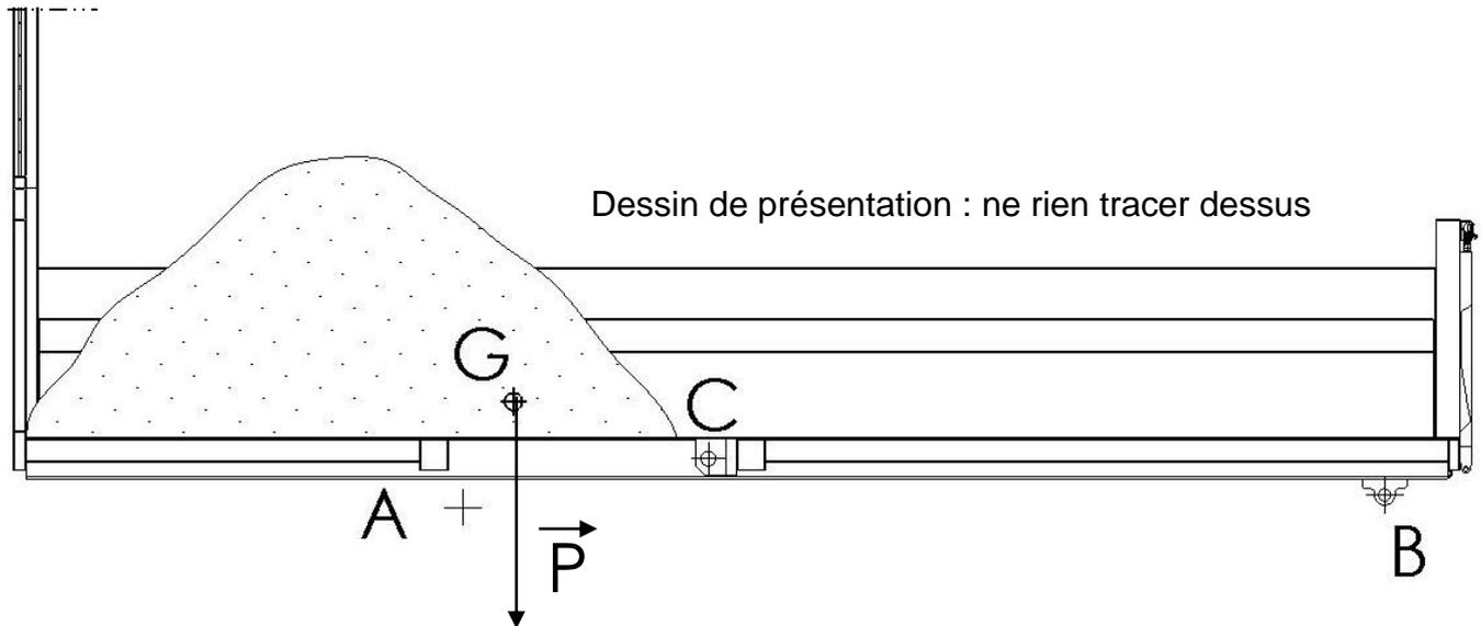
3.2.1 Isolez la benne (SE1) : Calculez le poids de l'ensemble matériaux + benne (SE1).
