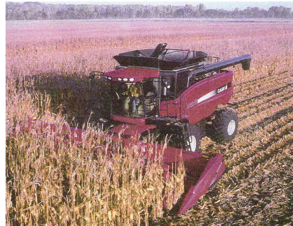
MOISSONNEUSE-BATTEUSE À BATTEUR AXIAL CASE IH AFX 8010
