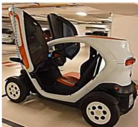
Lorsque le conducteur actionne le bouton d'ouverture de la portière, celle-ci s'ouvre automatiquement.
