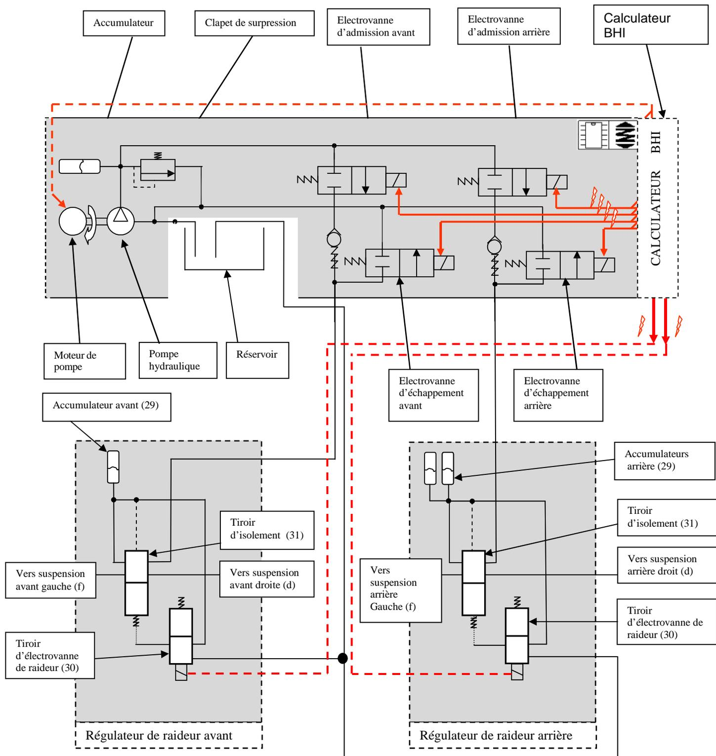
**Q9** - Tracer l'évolution de la pression en fonction du volume d'azote dans l'accumulateur de suspension arrière (voir DR9).
