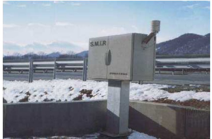
SMIR = Station Météorologique Interrogeable à Distance
