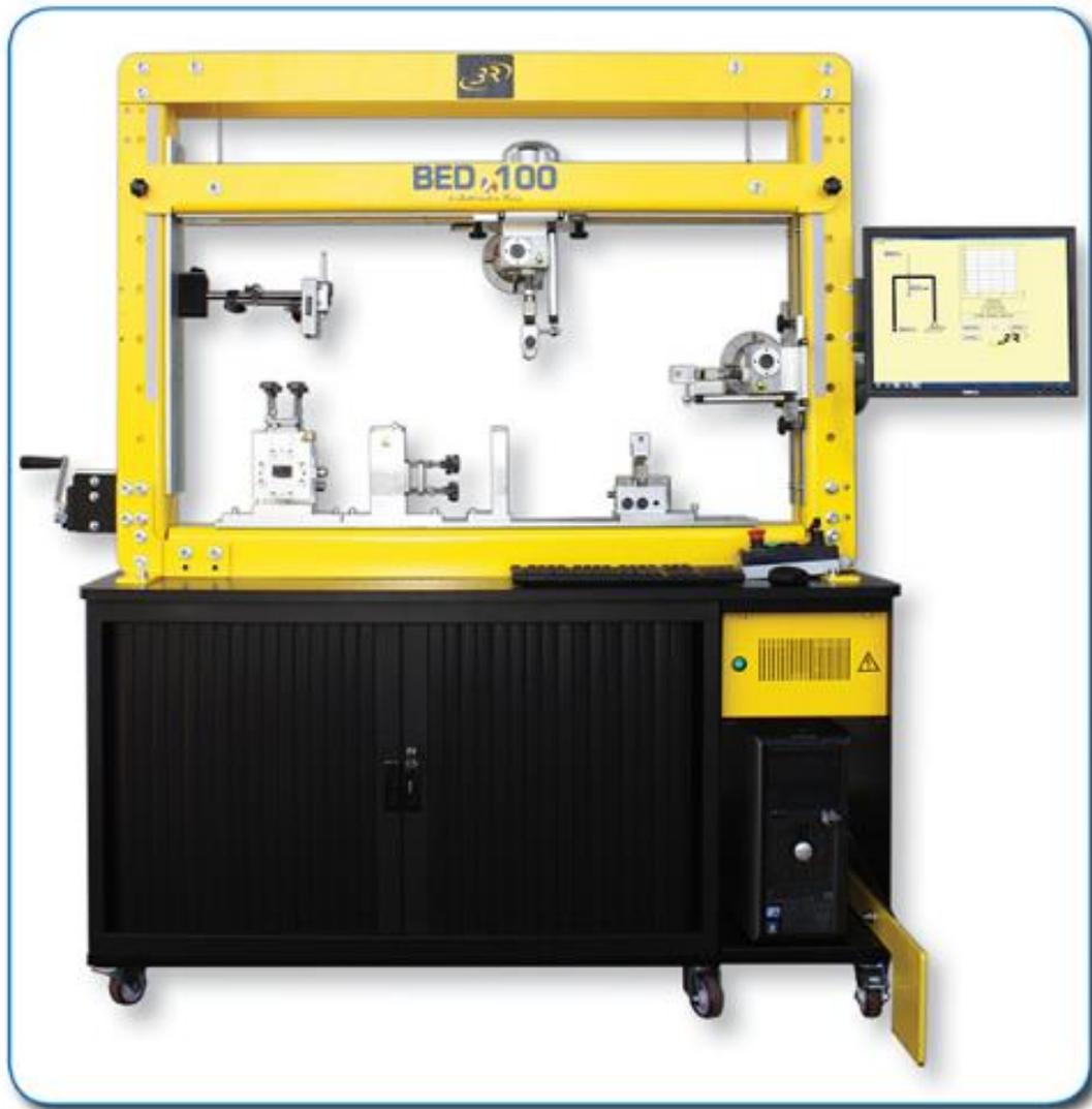
Développé pour l'enseignement, le BED 100 permet d'appliquer des sollicitations contrôlées sur des structures simples ou complexes afin de mettre en pratique les lois de comportement des matériaux, de dimensionner et étudier les contraintes et déformations dans une structure et aux liaisons.
