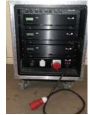
Baie de 3 amplificateurs D12 cour
