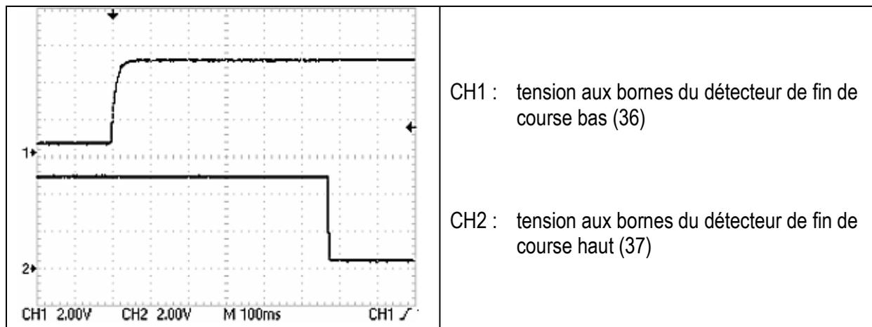
Figure 1 : oscillogramme relevé lors d'une commande en continu
