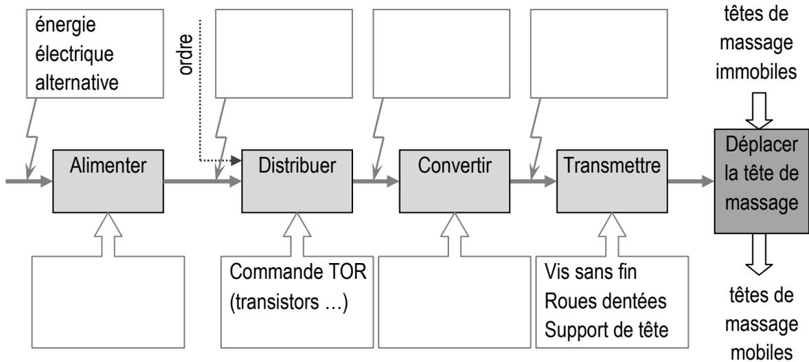
Q2) Diagramme FAST de la fonction technique « positionner les têtes en hauteur/profondeur »
