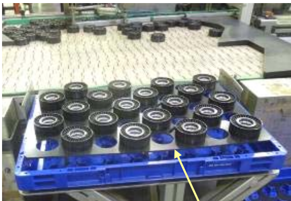
Plateau mobile en position haute lors du déchargement.
