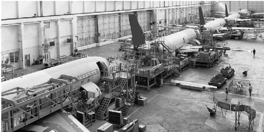
Cette chaîne d'assemblage final est constituée de plusieurs postes de travail d'une part dans un hall pour le montage, les essais électriques et hydrauliques, d'autre part à l'extérieur du hall pour les essais carburant et de mise en pression en air de la cabine, les essais moteurs et en vol pour la livraison client.
