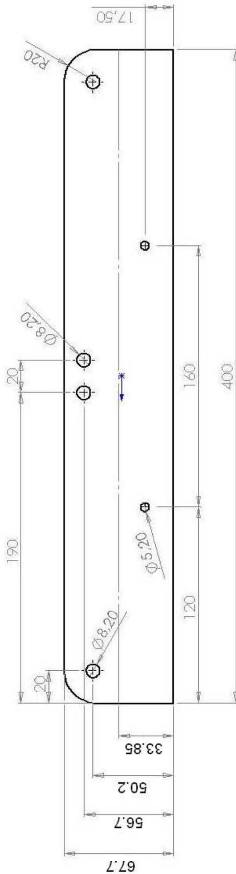
Trous de diamètre 5.2 à percer au moment de l'assemblage sur la ridelle
