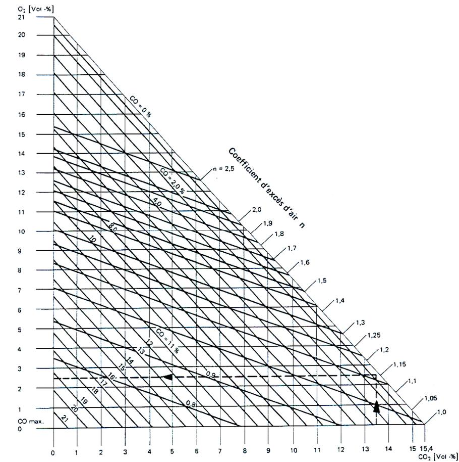
13. Déterminez le type de combustion en précisant le taux d'excès d'air, le rendement de combustion.
