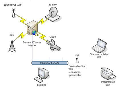
La topologie étoile utilisée conduit l'information vers le répartiteur général du local technique où se trouvent les deux commutateurs Dlynk DGS-1216T et Netgear FS 116P. Un serveur spécialisé développé par la société D&F est également présent dans cette baie de brassage. Il permet à l'ensemble du personnel de bord de communiquer avec l'extérieur en fonction des conditions de communication rencontrées (en mer, à quai,...).
