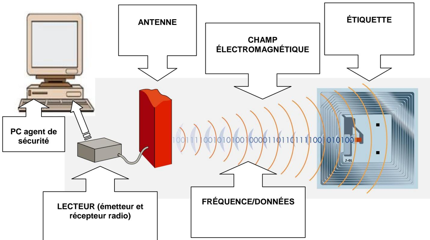
**Note :** la radiofréquence permet la DÉTECTION d'un marqueur non désactivé, la RFID permet l'IDENTIFICATION (numéro de série, données stockées dans l'étiquette) d'un objet étiqueté.
