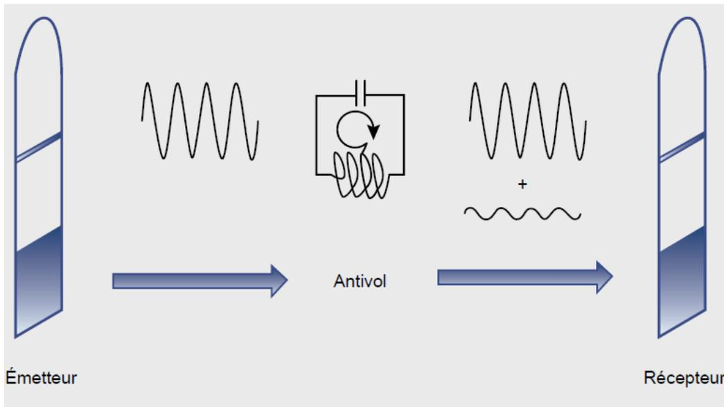
L'étiquette RFID contient un élément antivol qui envoie un signal à l'antenne, sauf s'il a été désactivé au moment de l'opération de prêt (par exemple d'un objet) ou de vente.
