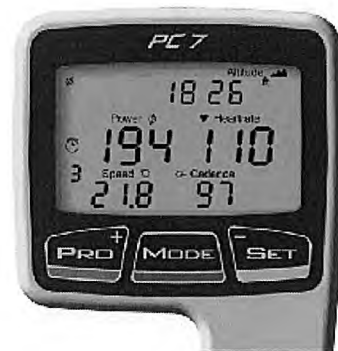
Système PowerControl de SRM
