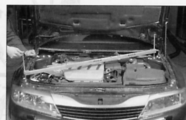
Contrôle N°3 : 1 557 mm, mesure entre la fixation avant droit d'aile et la fixation arrière gauche d'aile.
