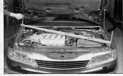
Contrôle N°6 : 1 414 mm, mesure entre le Mac Pherson droit et la vis gauche de fixation avant d'aile (contrôle symétrique).
