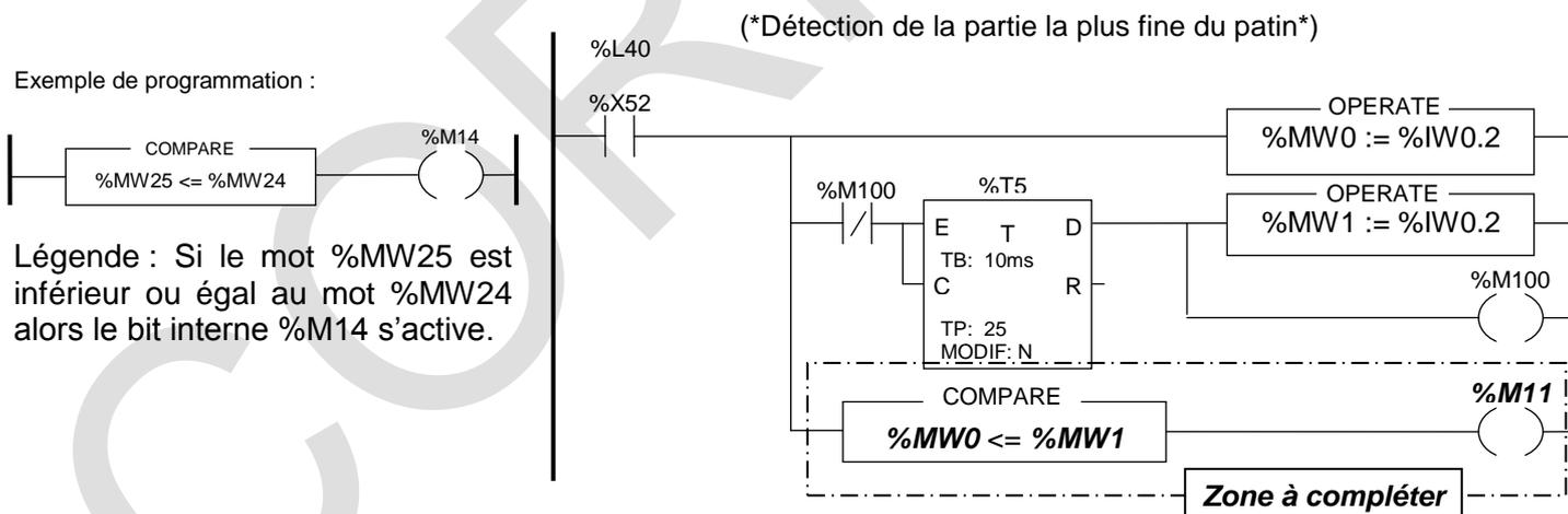
Note : une entrée analogique ne peut pas être directement utilisée dans un bloc de comparaison.
