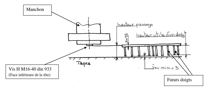
Quand le service de maintenance procède à un changement de la herse , il faut pouvoir la glisser entre le tapis et la face inférieure de la vis fixant le manchon. Pour ne pas détériorer le tapis on impose un jeu de 3mm entre l'extrémité des doigts et le tapis.
