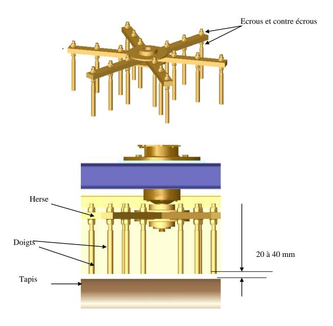
Le bureau d'études, après analyse des problèmes propose une modification du répartiteur de terre qui permettra d'améliorer le système de réglage et de réduire le temps d'intervention. La herse sera reconçue pour limiter les vibrations.
