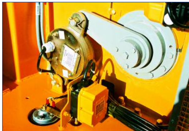
Sécurités électromécaniques et fins de course
