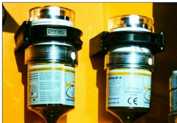
Graissage automatique de la couronne
