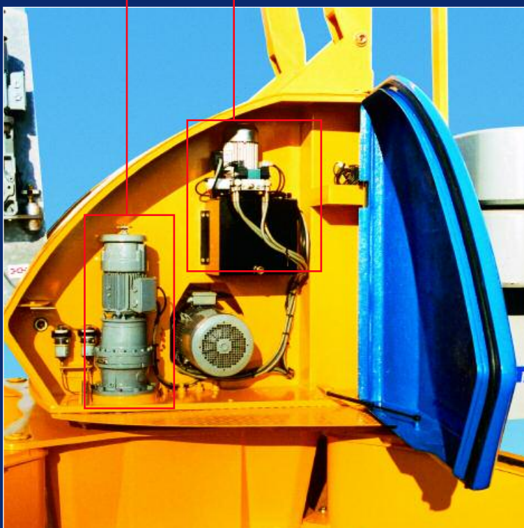
La centrale hydraulique équipée d'électrovannes
