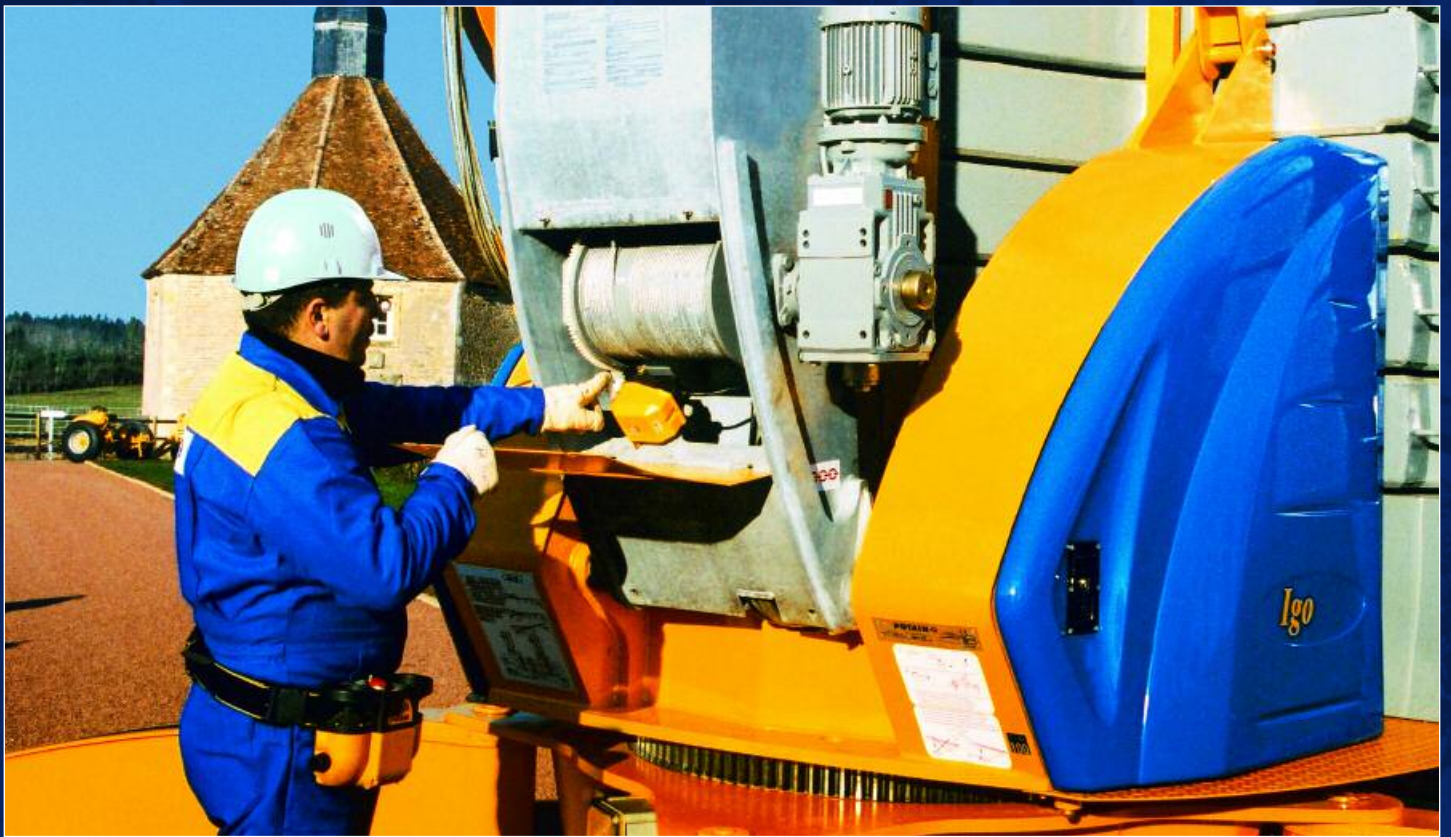
| Accès au treuil de distribution |
