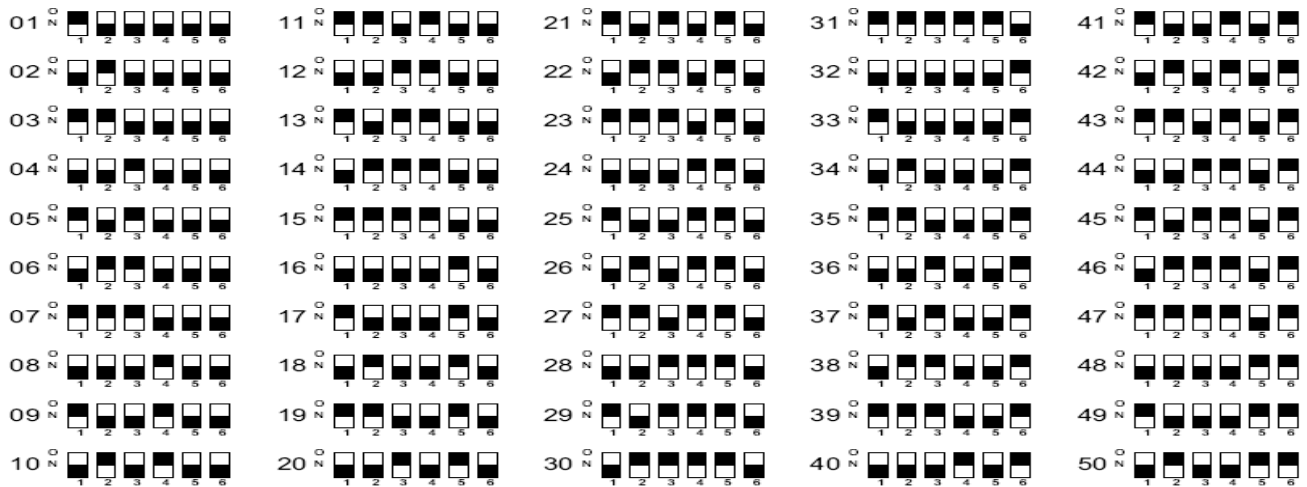
Correspondance entre n° de décodeur et position associée des switch
