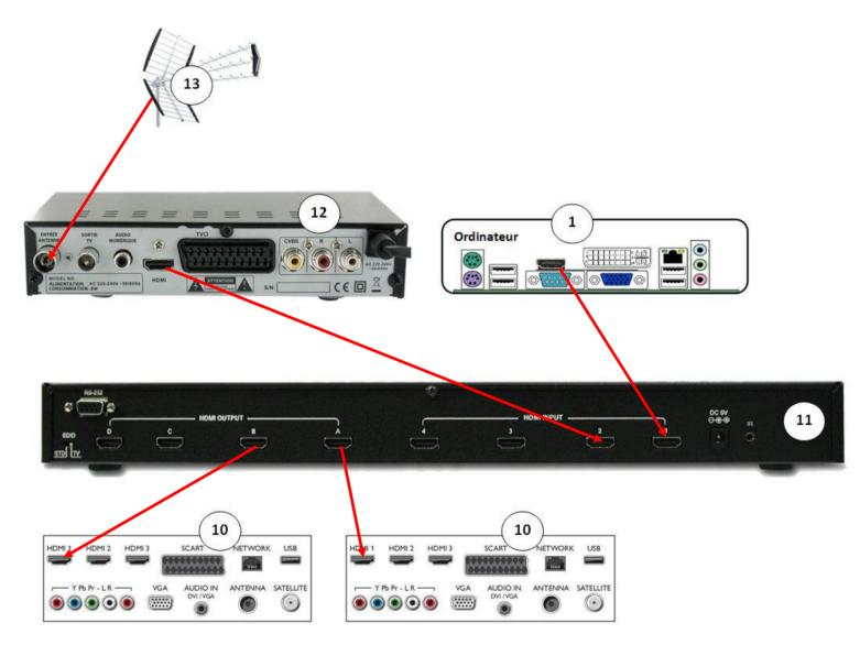
On accepte les connexions vers les entrées de 1, 2, 3 ou 4 de la matrice HDMI ainsi que les sorties A, B, C ou D de la matrice vers les prises HDMI 1, 2 ou 3 des téléviseurs
