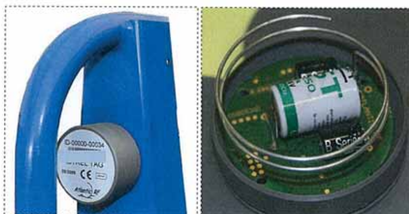
Figure A3 – Vues externe et interne d'une étiquette RFID active
