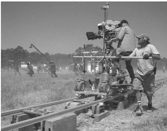
Figure 1 - Travelling obtenu par translation sur un rail
