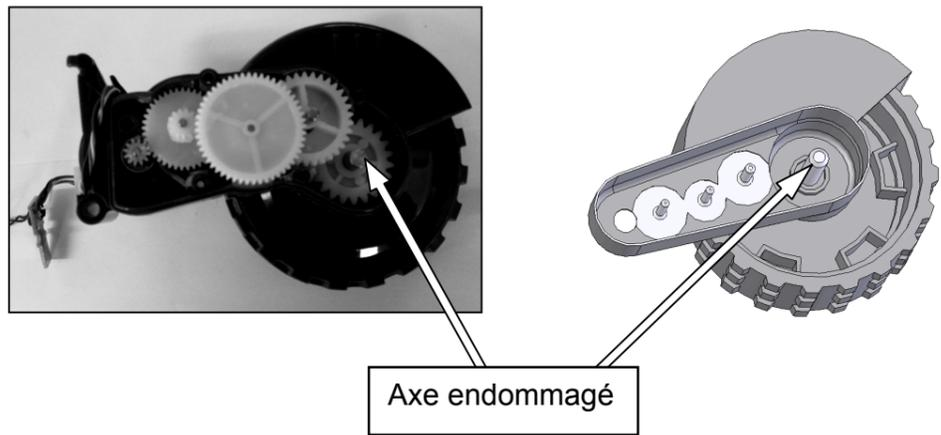
Pour le démontage de l'axe, il est nécessaire de réaliser un outillage spécifique permettant son démontage sans endommager le sous-ensemble **DT5/8**.
